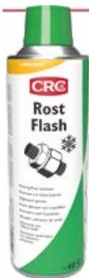
Dégrippant avec effet givrant. Après pulvérisation sur des pièces rouillées, la rouille refroidit rapidement (jusqu'à <math>-40^{\circ}\text{C}</math>) et se fissure en laissant de petites fentes. L'huile active pénètre rapidement dans ces petites ouvertures et libère facilement les pièces.
