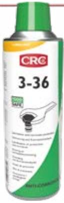
Inhibiteur de corrosion polyvalent aux propriétés hydrofuges et lubrifiantes. Forme un film protecteur mince, presque invisible et durable face à l'eau et l'oxygène. Propriétés de pénétration exceptionnelles, permettant au produit de pénétrer dans les pores et les fissures les plus infimes. Protège les pièces métalliques de la corrosion quand elles sont stockées en intérieur pendant une courte période.
