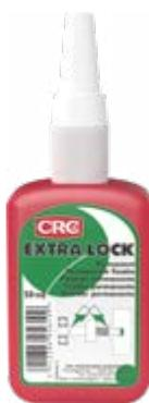
Scellement anaérobie durable et haute résistance pour filetages sur fixations métalliques et pour l'assise des roulements. Recommandé pour les raccords filetés M5 à M16 ainsi que pour les roulements et les coussinets.
